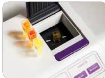
Küvetten-Schacht für Standard- und Mikroküvetten.
