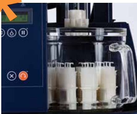
Halter für 12 Proben bei der Hydrolyse zum unbeaufsichtigten Betrieb und für einen höheren Durchsatz.
