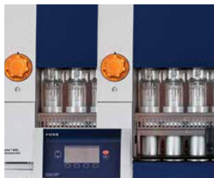
Steuerung von zwei Einheiten zur Lösungsmittelextraktion über ein Steuergerät für weniger manuelle Bedienung.
