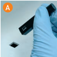
TrayCell in den Küvettenhalter des Spektralphotometers stellen.
