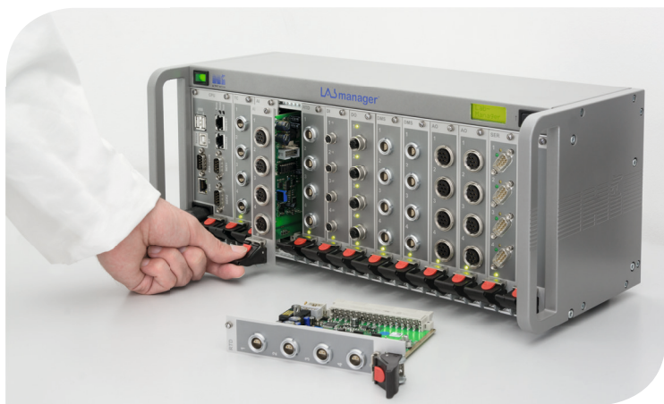
Einfacher „on-the-fly“ Wechsel der Einschubmodule
