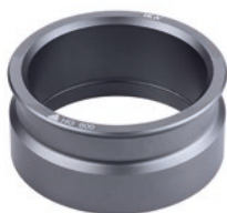
HG 600 Heizmantel Der Heizmantel verbessert die Wärmeübertragung in das Medium und reduziert die Aufheizzeit erheblich. Für Bechergläser mit 600 ml Volumen. Ident-Nr.: 0020003416
