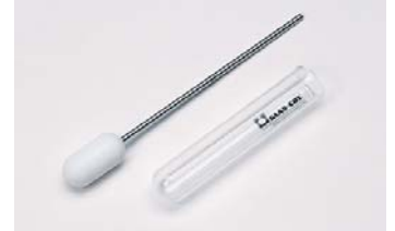
Glasgefäß als Zentrifugenglas, mit PTFE-Pistill, zylindrisch
