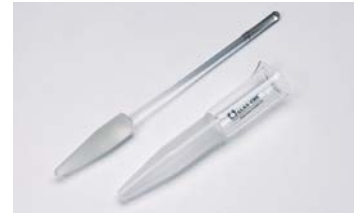
Glasgefäß mit Erweiterung als Überlauf, mit Ausguss, mit Glas-Pistill, konisch
