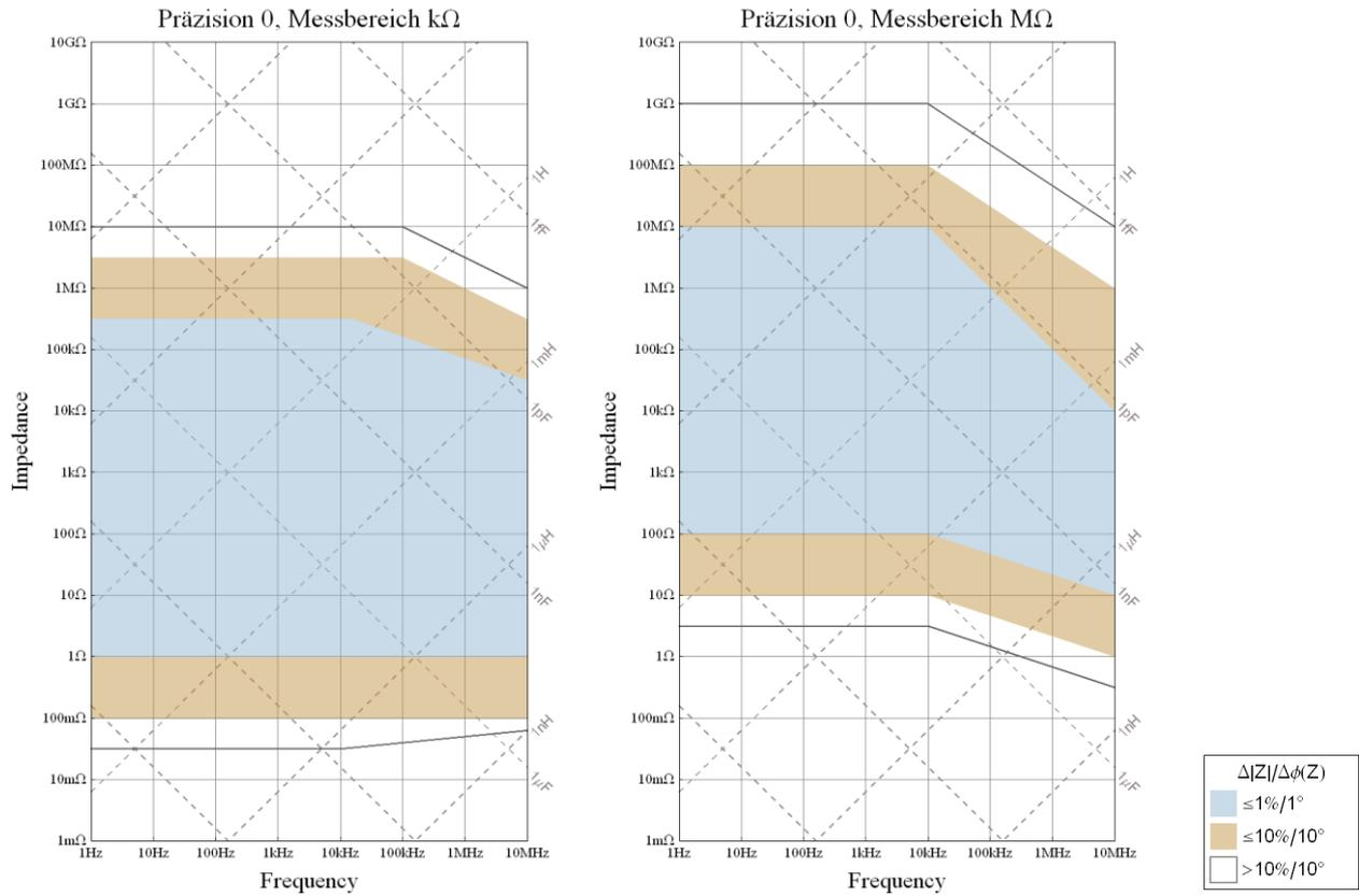
Alle Spezifikationen beziehen sich auf Messungen mit dem Sciospec ISX-5 und dem Sciospec MEA Rack mit einer Signalamplitude von 100mV und dem Frequenzbereich „<10MHz“.
