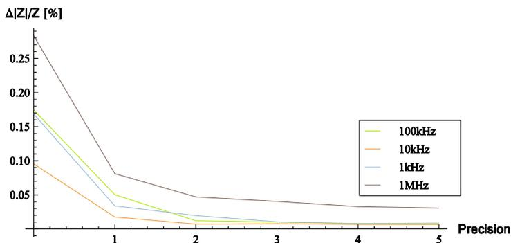
Einfluss der Präzisionseinstellungen auf die Messgenauigkeit und die Messzeit für die Messung eines Impedanzwertes bei der angegebenen Frequenz.
