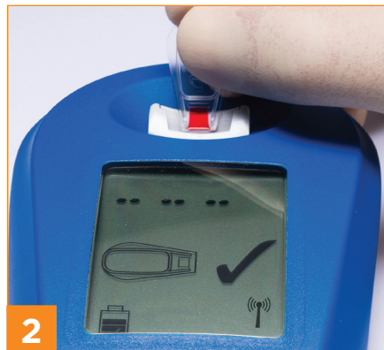
2 Gefüllte Küvette einsetzen und sanft nach unten drücken
