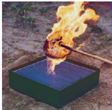
Wanne mit Wabengitter, Füllung in Portionen (3 x 2 Liter brennendes N-Heptan), Flamme verlischt 2-5 sec nach Einfüllung jeder 2-l-Portion.
