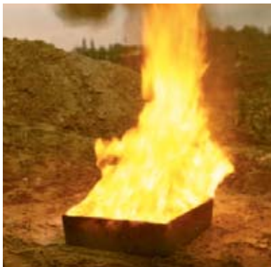
Leere Wanne ohne Wabengitter. Füllung 0,6 Liter N-Heptan, Flammenhöhe bis 2,2 Meter, vollständig verbrannt.
