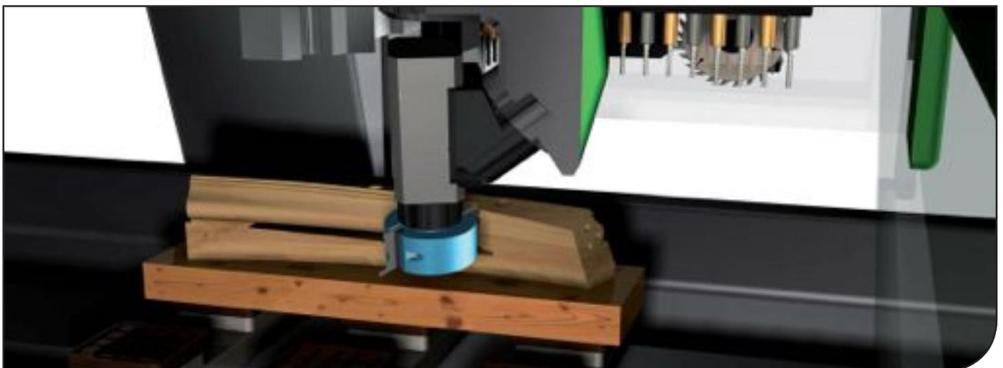
5-Achs-Bearbeitung mit TopSolid<sup>®</sup>WoodCam.
