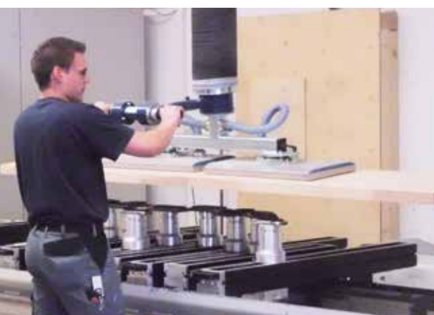
Handling von Holzbalken mit VUSS-Saugfuß
