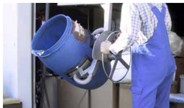
Manuelles Schwenken mit Handrad
