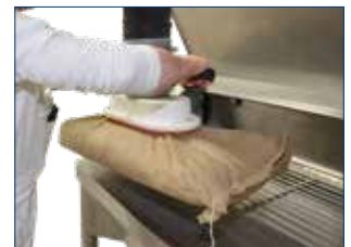
Sackheber (in V2A-Ausführung)
