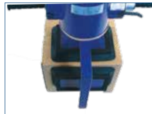
Kartonheber, Ansaugen von oben und seitlich
