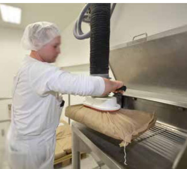
Handling von Säcken im Ex-Schutz-Bereich
