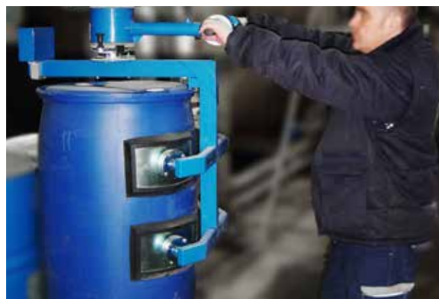
Vertikale Aufnahme von Fässern
