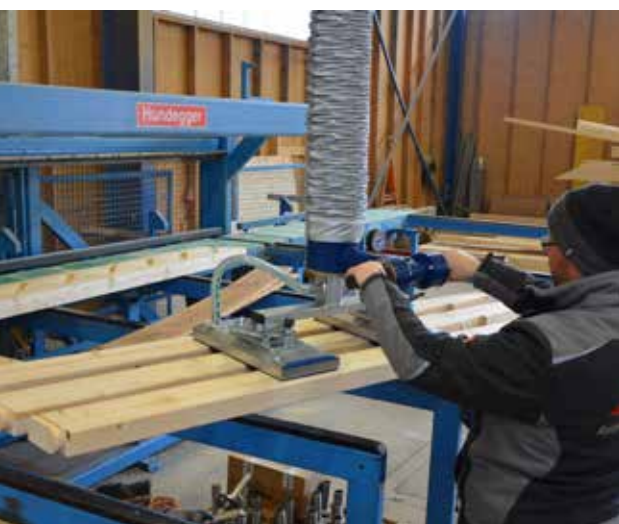
MULTI-LIFT mit Flächengreifer-Saugfuß für Holzleisten
