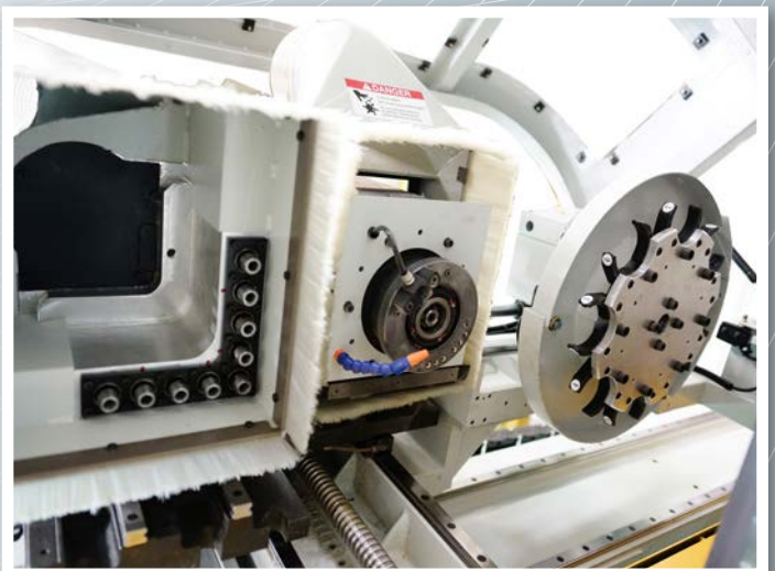
Die Anbringung des automatischen Werkzeugwechselrevolvers mit den stählernen Werkzeughalterungen direkt auf dem Spindelvorschub neben der Oberfrässpindel ermöglicht einen schnellen, effizienten und zuverlässigen Werkzeugwechsel.
