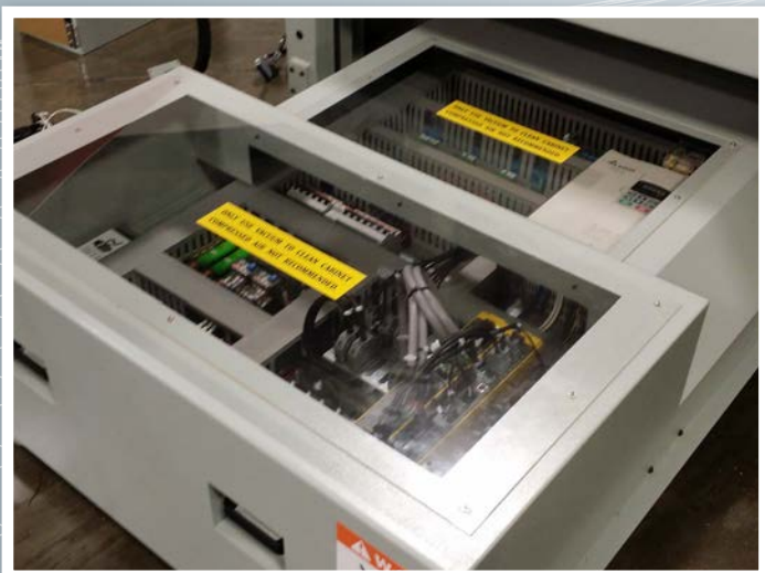
Die Elektronik ist in einer speziell konstruierten, abgedeckten und abgedichteten Schublade untergebracht, die sich im Betrieb unter der Grundplatte der Maschine befindet. Dieser Aufbau spart nicht nur Platz, sondern macht auch viele Drähte überflüssig, die ansonsten über den Boden zu führen wären.
