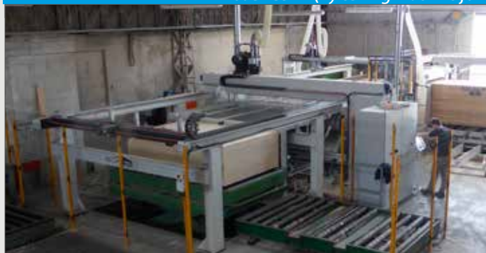
Sezionatrice-riflatrice per pannelli di compensato e derivati (H 80 mm) Saw blade and trim cut machine for plywood panel (H 80 mm)
