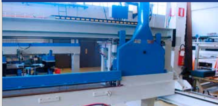
Modul-CONT (Gruppo di taglio ad inseguimento per produzione in continuo) Modul-CONT (Fly cutting machine for continuous production)
