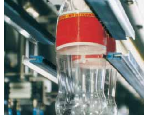
Zum Führen von PET-Flaschen For guiding PET bottles Pour guider des bouteilles en PET
