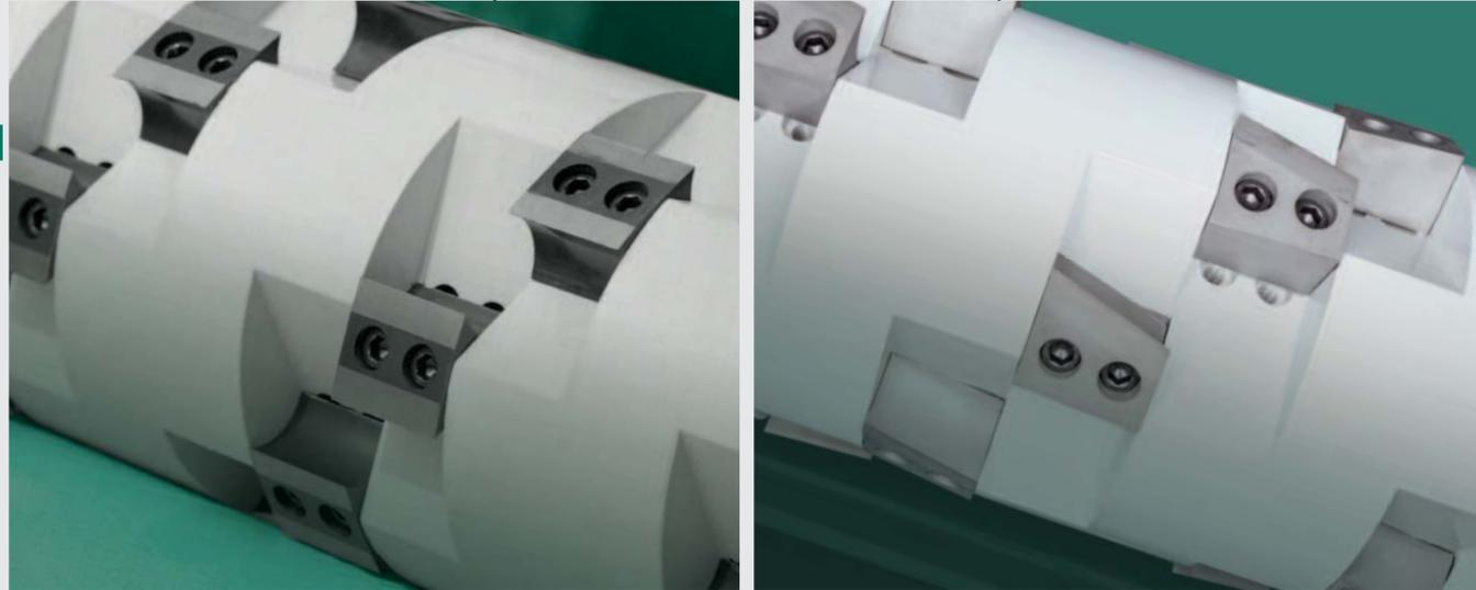
Das Herzstück der Wurzelreduzierer: die Fräswelle mit spiralförmig angeordneten und vierfach wendbaren Messern aus spezialgehärtetem Stahl.
