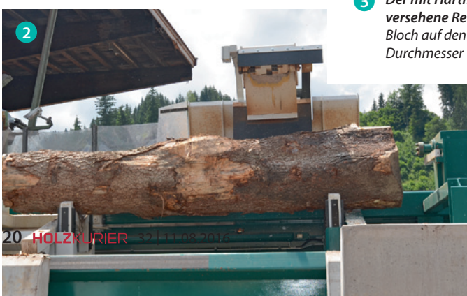
2 Vor der Bearbeitung vermisst ein Laser den Stamm
