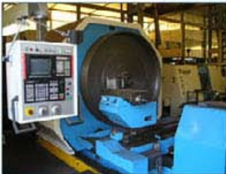
Mecanizado de un volante en un torno CNC.
