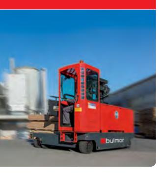
Die Mehrwege-Seitenstapler sind mit bis zu zweimal Vierfachlasträdern ausgestattet, was einen geringeren Verschleiß durch besseres Abrollverhalten bei Lenkbewegungen verursacht.
