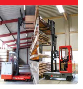
Der außerordentlich leistungsstarke und trotzdem leise Elektroantrieb unserer Mehrwege-Seitenstapler spart Ihnen Kosten, ist umweltfreundlich und überzeugt bei den schwierigsten Situationen im Innen- und Außeneinsatz und auch im Mehrschichtbetrieb. Verschiedene Tragfähigkeiten von 2 bis 6 Tonnen sind möglich. Je nach Kundenanforderungen sind zudem verschiedene Kabinenvarianten, wie Quer-, Längs- oder Diagonalkabine, möglich.
