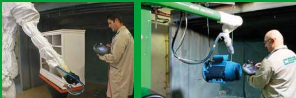
**IT** Per la programmazione detta Punto a Punto (PTP) è necessario memorizzare tutti i punti del programma per mezzo di un Mobil Panel in modo da creare le traiettorie del ciclo ed impostare tutti i parametri utili alla verniciatura finale. È anche possibile l'acquisizione dei punti muovendo manualmente il robot. Durante questo processo il robot viene messo fuori produzione per la programmazione ed il test del programma eseguito.
