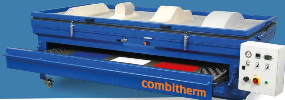
COMBITHERM ist eine kombinierte Aufheiz- und Formstation in sehr kompakter, platzsparender Bauweise. Die Verbindung einer Aufheizstation mit einer Vakuumpresse ermöglicht Werkstoffe in unterschiedlichen Stärken und Qualitäten durch Umluftwärmung rasch und absolut gleichmäßig aufzuheizen und anschließend mit Vakuum umzuformen.
