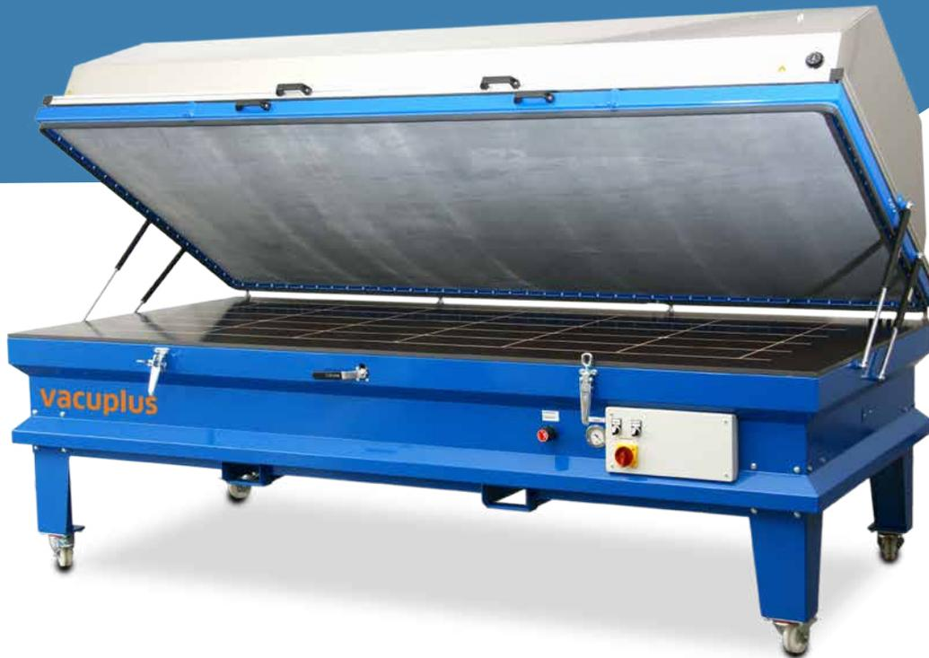
VACUPLUS ist eine Membranpresse mit einem hervorragenden Preis-Leistungsverhältnis, die dem Anwender ungeahnte Möglichkeiten bietet, formverleimte oder formbeschichtete Möbel, Einrichtungsgegenstände und Sonderanfertigungen herzustellen!
