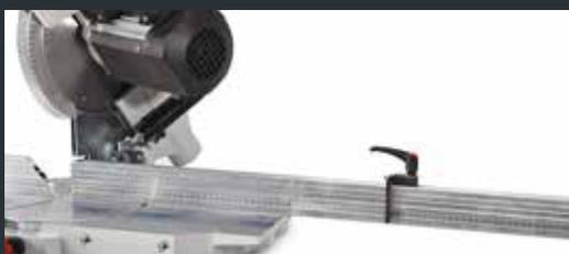
Anschlagverlängerung + manueller Ablänganschlag (2P 300 -2L 300)
