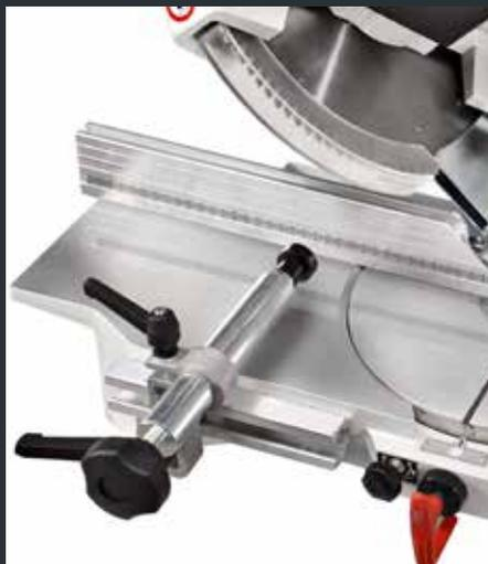
Waagrechte manuelle Spannvorrichtung (2P300)
