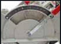
**2L 300** Positionierung des Aggregates auf den Festpunkten: (90° - 15° - 22° 30' - 30° - 45° rechts und links).
