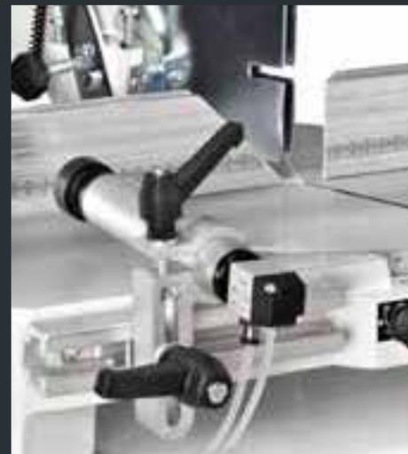
Waagrechte pneumatische Spannvorrichtung (2P300)
