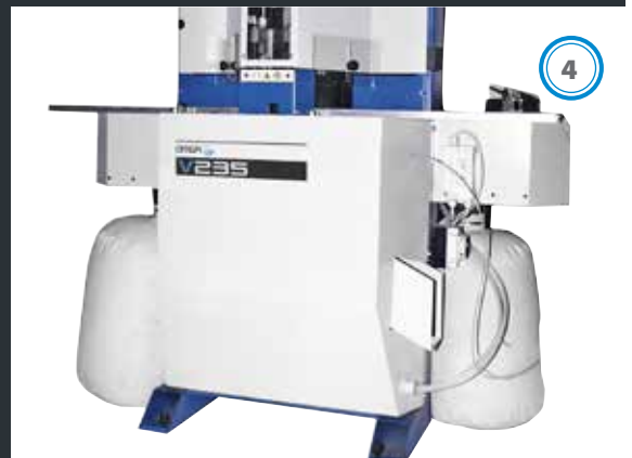
Absaugung in 2 Einheiten. Separate Absaugung an jedem Anschluss: Ø 80 mm Absauggeschwindigkeit: 20 m/sec Absaugmenge pro Absauganschluss: 320 m 3 /h (V235 - V235 FNC)
