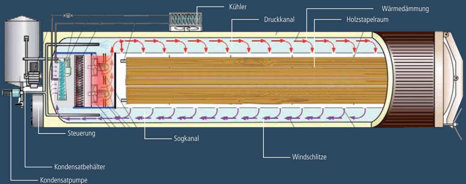
Die Trockenanlage bei der Umwälzung als grafischer Querschnitt dargestellt. Ansicht von oben.
