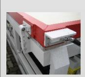
Robuster und solider Aluminium-Arbeitstisch mit Vakuumsaugfläche
