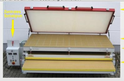
Stabiler, geschweißter Aluminiumrahmen mit Hochleistungs-Silikonmembrane massive 12mm Vakuumarbeitsplatte aus Aluminium Vakuumspeicher im Maschinenrahmen zentrales Bedienpult **Extrem stabile Maschine** aus Stahl, verwindungsfrei verschweißt Heizstation mit oberer und unterer Industrieheizplatte 18 mm dick, kugelgelagerte Schublade, extrem schnelles Öffnen und Schließen
