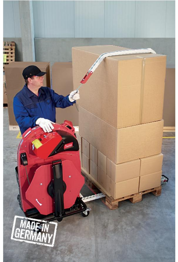
**Auch hohes Packgut ist für ErgoPack-Systeme kein Problem: Mit einem Zusatz können Paletten sogar bis zu 3,0 Meter Höhe sicher und schnell umreift werden.**
