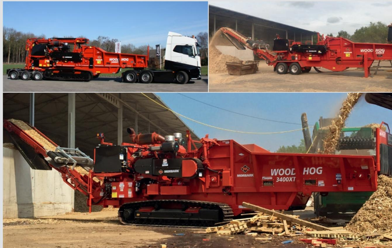
Als Laufwerk stehen Kettenantrieb (XT-Version), 3-Achsen-Anhänger (X-Version) oder 3 Achsen Dolly (XT-Version) als Ausstattung zur Verfügung. Auch ist die Maschine als Elektroantrieb verfügbar. Effektivität und Flexibilität sind Maximal gegeben. Abmessungen und Transportgewichte sind dabei berücksichtigt.
