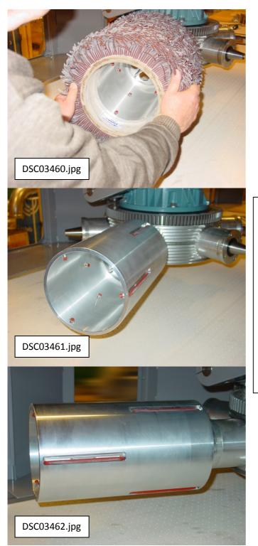
So einfach sind die Werkzeuge auf der LOCK-IT Spindeln auszuwechseln: Ohne Anwendung von Werkzeugen lässt sich die Spindel verriegeln, das Werkzeug drehen und abziehen.
