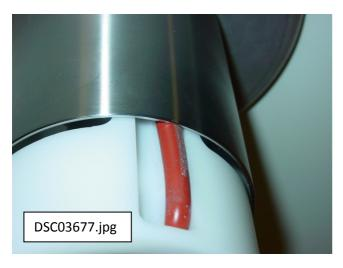
Wenn der Zylinder am Platz sitzt, dreht man ihn nach rechts, wodurch das elastische Band aus der Rille gezwungen wird und damit den Schleifzylinder in der gewählten Position verriegelt.
