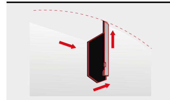
Automatische Justierung des Schneiddurchmessers nach dem Nachschärfen.
