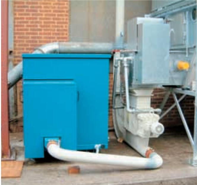
Das Bild zeigt die Antriebsstation für die Austragung des Spülluftfilters mit untergeflanschter, druckstoßfester Zellenradschleuse. Das ausgetragene Schüttgut wird mittels eines Drehkolben-Gebläses zum 120 Meter entfernten Bunker gefördert.
