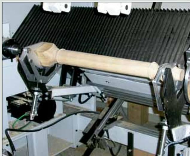
Das neue selbstzentrierende Magazin positioniert sowohl gehobeltes als auch sägerauhes Holz, mit Querschnitten von 20 bis 120 mm, exakt zwischen die Spitzen. Die Länge lässt sich zwischen 200 mm und 1.600 mm schnell einstellen.
