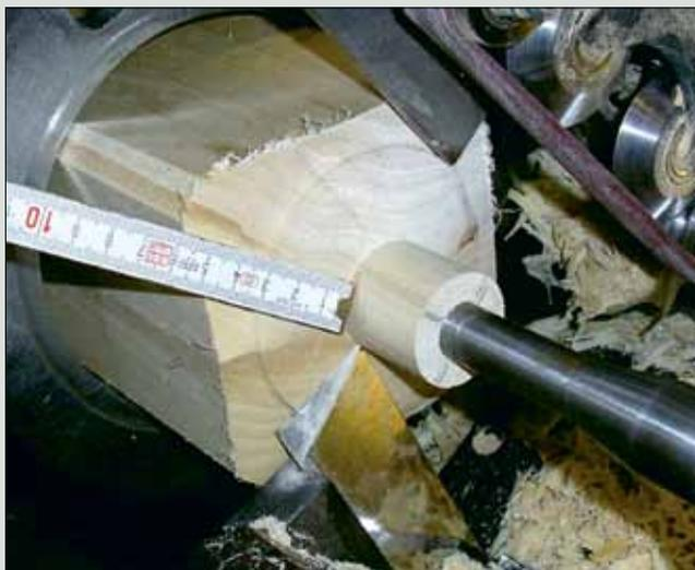
Grobwerkzeug für höheren Vorschub und Schnittleistung. Paralleler Einsatz des Feinwerkzeugs für genaueste Konturen kombiniert mit Schwenkmeissel. Die Steuerung erkennt automatisch den Einsatz von Grob- und Feinwerkzeug.
