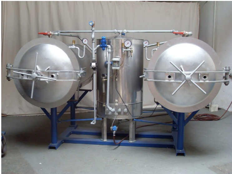
Dampfgenerator mit 2 Kesseln
