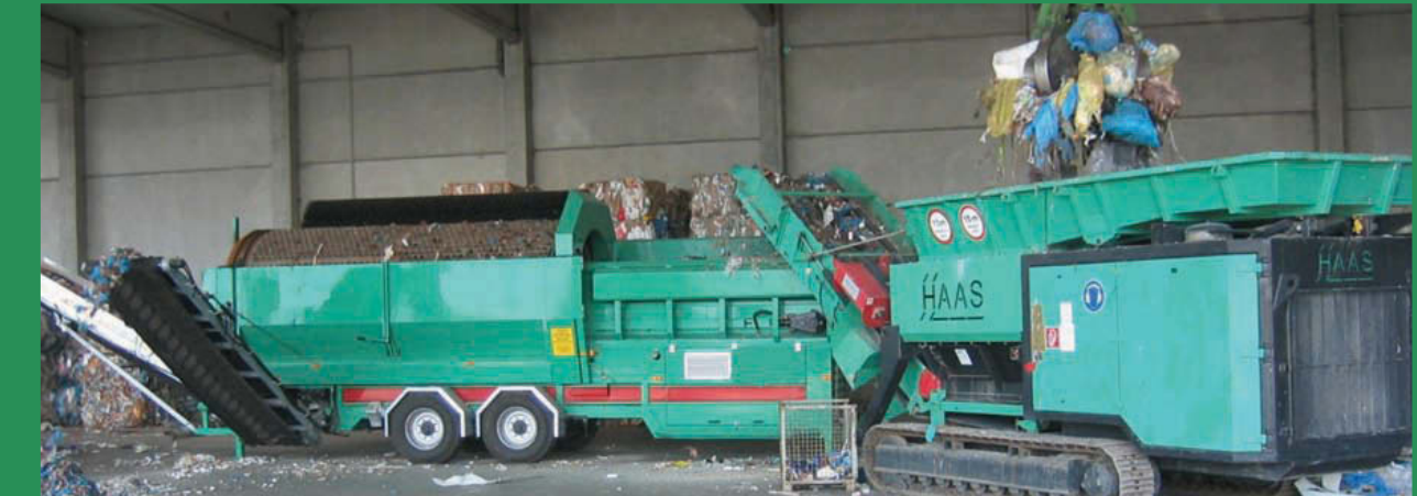
Mobiles Trommelsieb mit mobilem HAAS Vorbrecher
