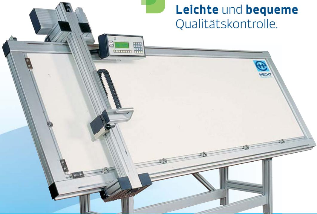
Der **Standard-DesQ** erlaubt das **präzise Vermessen** flächiger Werkstücke und kommt bei der Möbelherstellung sowie bei der Produktion von Fassaden-, Boden- oder Akustikdeckenelementen zum Einsatz. Höchste Präzision und einfache Handhabung sind die hervorstechenden Merkmale dieser Messvorrichtung. Zum Betrieb ist keine Software notwendig. Optional kann der Standard-DesQ mit Z-Achse für Tiefenmessungen, einem 6-fach Revolverkopf oder mit einer Vakuumspanneinrichtung geliefert werden.
