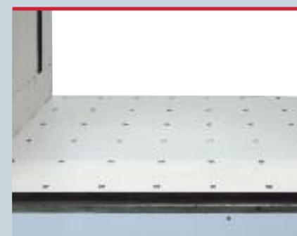
**Luftdüsen im Pressboden**
