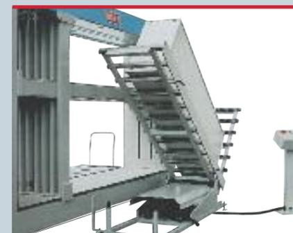
**Kombinierte Aufrichtstation und Auslaufrollenbahn mit Allseitrollen**
