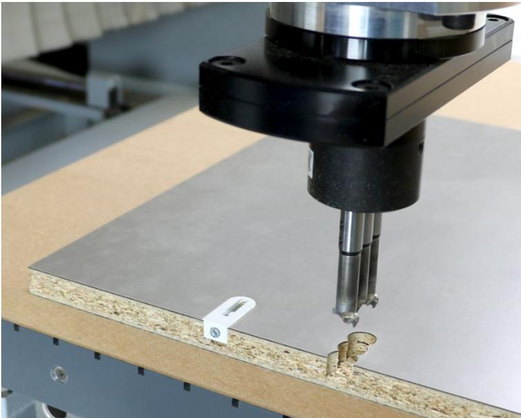
**Bild:** Die N-600 kann optional sowohl die entsprechenden Bohrungen für einen Verbinder vornehmen, als auch ab der LIGNA auf Wunsch den Verbinder direkt eindrücken. Hier als Beispiel: Cabineo
