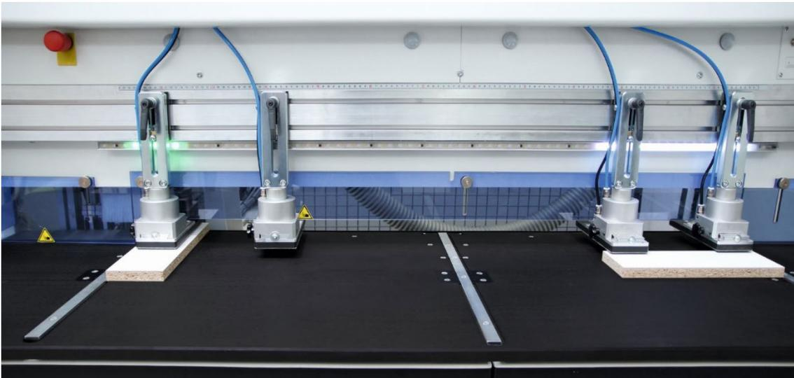
**Bild:** intelliGuide – Die LED-Leiste leuchtet dort, wo die Werkstücke positioniert werden sollen. Sobald die Positionierung korrekt ist, wechselt die Farbe der LED-Leiste. So erhält der Bediener eine Absicherung der Prozessqualität
