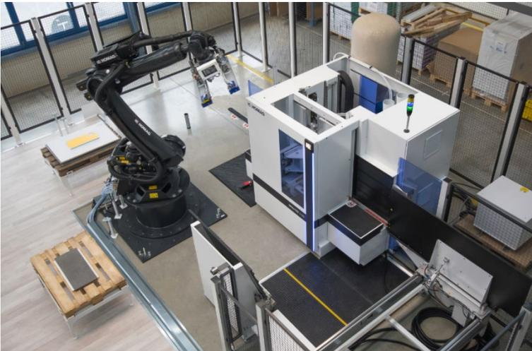
**Bild:** Eine Roboteranbindung ist bereits bei den HOMAG Einstiegsmaschinen möglich (hier: **DRILLTEQ V-Serie**). Das sichere, präzise und automatische Belegen, Entnehmen und Ab stapeln von Werkstücken bringt eine effizientere Produktion
