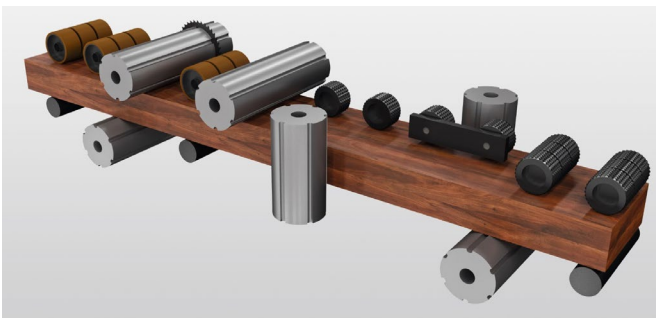
Bild: 6 Bearbeitungsspindeln – die optimale Bestückung für Fenster-, aber auch Türen- und Leistenhersteller
