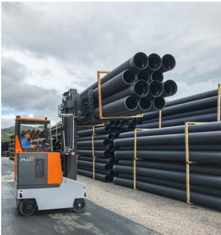
Das Fahrzeug ist bestimmt für das Handling von Paletten und Langgut zu gleichen Teilen.
