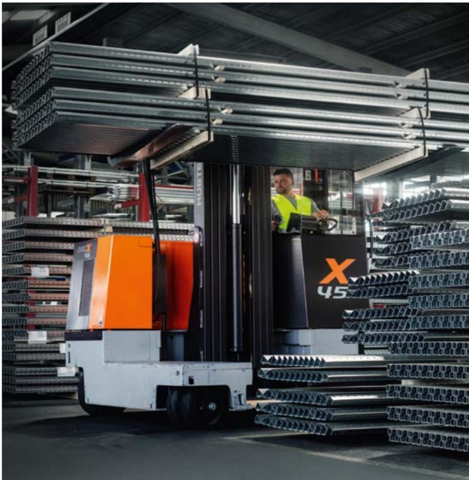
Mehrwege-Seitenstapler mit Elektroantrieb eignen sich zum vielseitigen Handling von langen und sperrigen Lasten und werden an die individuellen Anforderungen der Kunden angepasst und entsprechend gefertigt. Sie können im Innen- und Außeneinsatz individuell eingesetzt werden.
