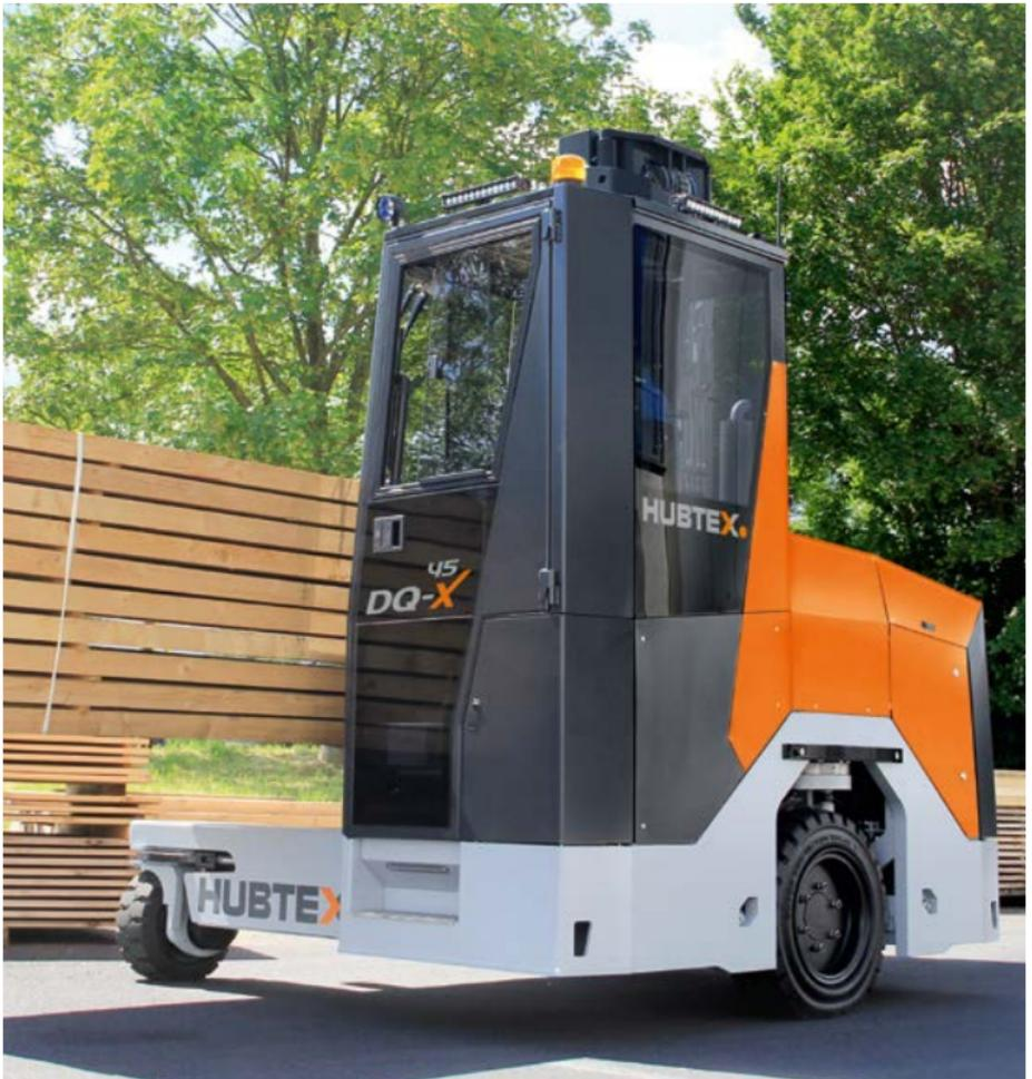
Die kompakten Vierwege-Seitenstapler mit leistungsstarken Diesel- oder Gas-Antrieben sind für den Außeneinsatz konzipiert.
