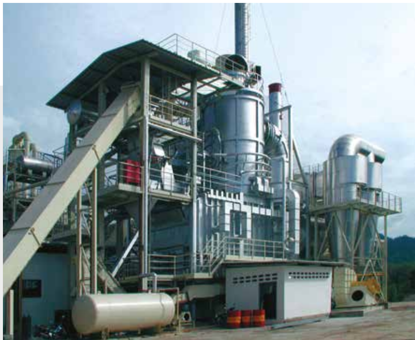
Feststofffeuerungsanlage mit Schleifstaubverbrennung, Leistung 11 MW, Thailand
