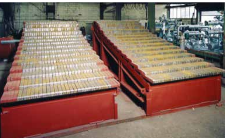
Vorschubrost für die Verbrennung von Biomasse
