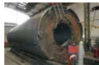
Strahlungskessel mit Einbauöffnung für Staubbrenner, mit gekühltem Feuerraumdeckel
