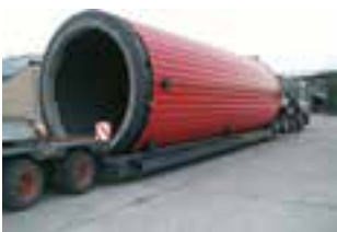
Schleifstaub /erdgasbefeuerter Thermalölerhitzer mit einer Leistung von 16 MW, Aufstellungsland Belgien
