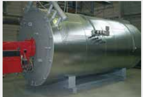
Erdgasbefuerter Thermalölerhitzer für die Lebensmittelindustrie mit einer Leistung von 1,6 MW, in Texas, USA
