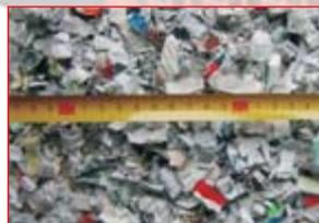
Broyeur modifié traitant du papier et du carton pour produire des copeaux avec le grain permettant le **briquetage**
