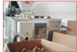
Broyeur peut être monté directement au-dessus de la trémie d'alimentation de la **presse à briquetter**. Briquettes en papier ou en carton sont devenues combustible solide reconnu
