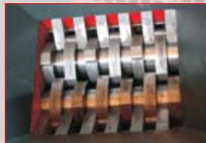
**Les outils** de broyage sont des disques avec des dents montés sur deux arbres tournants à contre-cour
