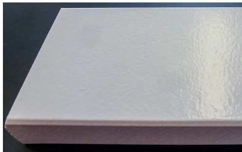
Feuchtebeständige MDF mit 2-Schicht-Pulverlackierung (Grundierung und Decklack) Quelle: Woodkplus
