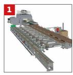
Bei der Herstellung von BSH wird der Leim von oben aufgetragen. Die geleimten Lamellen werden einzeln quergeführt, aufgerichtet, gesammelt und zu einem Block festgehalten. Darauf wird der Block auf das Förderband des Auflegesystems gelegt, das ihn in die Presse leitet
