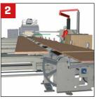
Bei der Herstellung von BSP wird der Leim bei den Längslamellen von der Seite aufgetragen. Die Lamellen werden auf eine vorläufige Sammelstelle quergeführt, wo sie zu einem Block gesammelt werden, der anschließend auf das Förderband des Auflegesystems gehoben wird, damit weitere Schichten hinzugefügt werden können.
