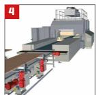
Das aufgelegte Pressgut wird in die Hochfrequenzpresse geleitet, in der es von oben und von der Seite gepresst wird, während die HF-Energie blitzschnell den Kleber aushärten lässt.
