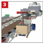
Ein spezialkonstruierter Leimwagen trägt Leim auf die Längslamellen, und die Querlamellen werden mit Hilfe eines Vakuumhebers auf dem Leimwagen hinzugefügt.
