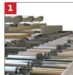
Die Linie wird von einem doppelten Schnellrollgang versorgt, was den schnellen Transport der Lamellen zu dem Auflegesystem erlaubt. Die Lamellen werden in zwei Stufen quergeführt, um zu verhindern, dass sie während des Transports aneinander laufen. Sie werden entweder von den Rollgängen direkt in die Aufricht-Einheiten quergeführt oder aber auf Kettenbahnen zwischen Rollgängen und Aufrichtern geleitet.
