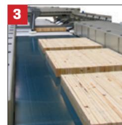
Das Einlaufband vor der Hochfrequenzpresse ist mit Seitenstützen versehen, um zu verhindern, dass insbesondere kurze Lamellen während des Transports in die Presse umfallen. Die komplette Presselinie wird von einem zentralen Steuersystem gesteuert, in dem alle Daten von den Leim- und Pressvorgängen erfasst und gespeichert werden.
