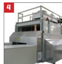
Um die Fertigungslinie bei einer auftragsbezogenen Produktion weiter zu optimieren, kann die Presse mit einer halbautomatischen Einstellung der Presshöhe und mit Seitendruckbreiten von 1280 mm bis zu nur 240 mm ausgestattet werden. Diese beiden Funktionen ermöglichen, dass verschiedene Produkte rasch nacheinander gepresst werden können, und dass auch ein Balken oder eine sehr niedrige Anzahl Balken laut Auftrag selbständig hergestellt werden können. Das Schlüsselwort ist Flexibilität.
