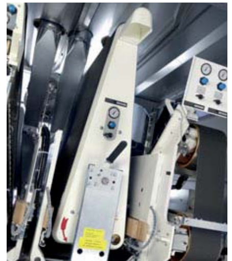
Longitudinal sanding unit
