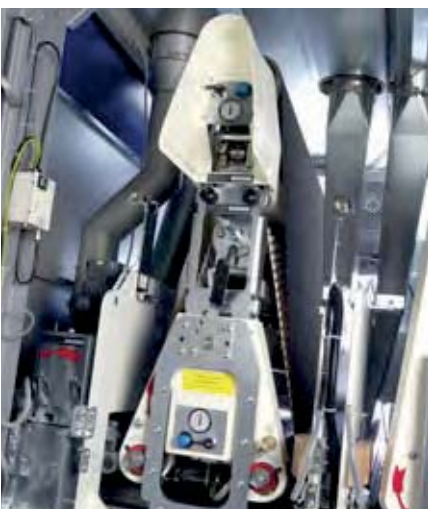
Längsschleifaggregat (mit Drucklamellenband)
