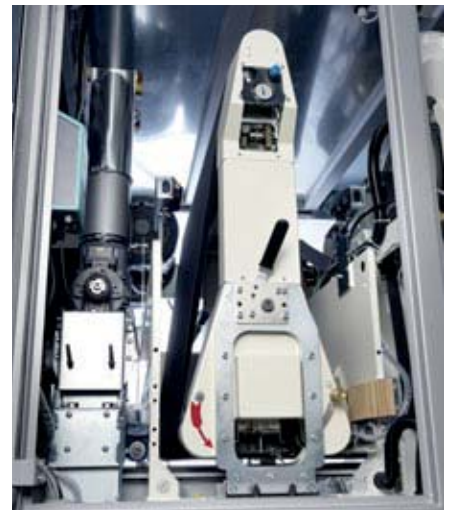
Längsschleifaggregat (mit oder ohne Drucklamellenband)
