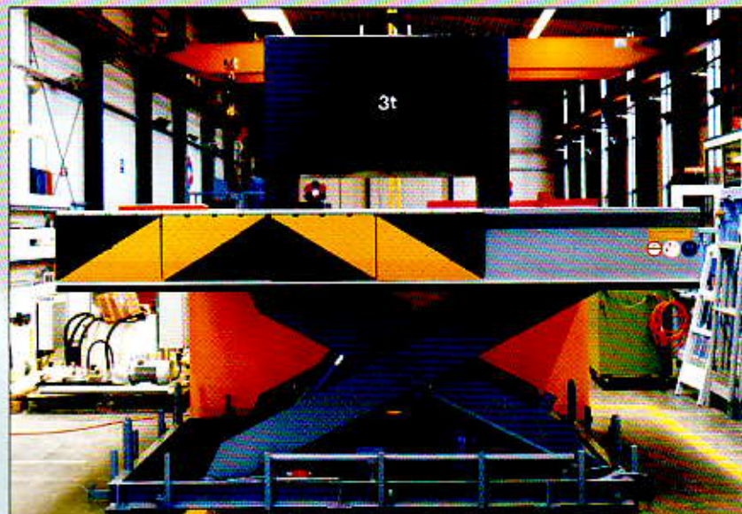
Alle Hubtische werden mit Prüfgewichten belastet. All lift tables are loaded with test weights.
