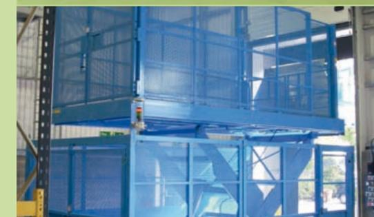
LAWECO DOPPELDECK-SCHERENHUBBÜHNE mit umbauender Stahlkonstruktion
