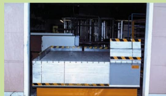
LAWECO HUBTISCH mit Ladebrücke, Unterlaufschutz und Abrollsicherung
