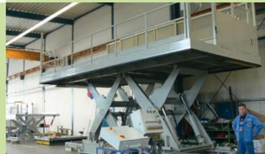
LAWECO VERLADEHUBTISCH mit hydraulischer Ladebrücke, Geländern und Türen
