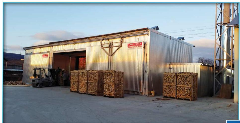
**Typy suszarni.** Firma LE.KO oferuje suszarnie konwekcyjne w standardowym wykonaniu ze stropem pozornym zabudowanym ponad wsadem. W zależności od wielkości komory i jej proporcji wymiarowych cyrkulacja powietrza odbywa się w osi wzdużnej lub poprzecznej do otworu drzwiowego. Drzwi zaladowcze mogą być otwierane na zawiasach, lub też unoszone i przesuwane za pomocą specjalnego mechanizmu przemieszczającego się po torze zawieszonym na ścianie czołowej urządzenia.
