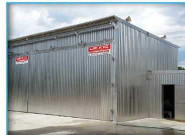
**Параметры сушильной камеры.** Фирма LE.KO предлагает сушильные камеры для пиломатериалов конвективного типа в стандартном исполнении с попечечно-вертикальной циркуляцией сушильного агента. Загрузка камер может осуществляться автопогрузчиком или по рельсовому пути. Двери камер открываются на петлях или с помощью специального подъемного механизма. Поставляемые нами сушильные камеры могут быть однокамерными или монтироваться в блоке из нескольких сушилок, в том числе с разным объемом загрузки.
